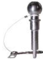
25mm-Kugelhkopf, Sicherheitsseil, Lasche, Splint für Universelle 3,5-t-Kupplung E100TC Best.-Nr.: 185005515 (Bradley Kit172) SAP: 25MM KUGELKOPF + SEIL + SPLINT E100TC
