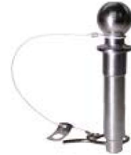
32mm-Kugelhkopf, Sicherheitsseil, Lasche, Splint für Universelle 3,5-t-Kupplung E100TC Best.-Nr.: 185012715 (Bradley Kit170) SAP: 32MM KUGELKOPF + SEIL + SPLINT E100TC
