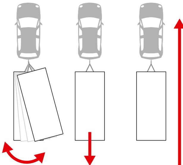
Le comportement routier de la caravane ou remorque est contrôlé en permanence par l'ATC. Les capteurs détectent des mouvements latéraux dangereux directement sur l'essieu de la caravane ou remorque, avant qu'un ESP présent dans la voiture puisse enregistrer le mouvement d'oscillation de l'ensemble attelé.
