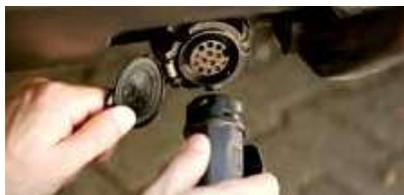
La conexión eléctrica con el turismo se realiza mediante el conector de 13 polos.
