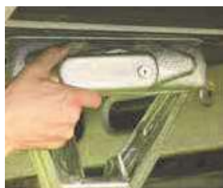
Positionner le Safety dans les fentes de logement et pousser vers la droite.
