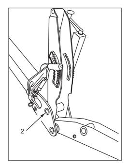
Mettre les 2 bielles réglables (partie supérieure et inférieure) en position verticale.
