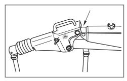
Retirer le circlip de l'écrou papillon.
