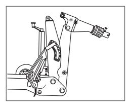
Déclipser la pièce de sécurité sur le joint de la rotule de l'amortisseur à gaz. Faites maintenant descendre la partie inférieure de la bielle réglable.
