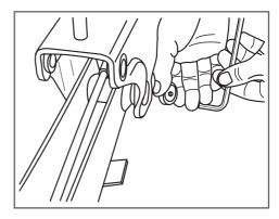
Dévisser l'écrou de fixation du dispositif d'attelage et desserrer l'écrou de liaison du câble Bowden. Le câble Bowden peut maintenant être enlevé.
