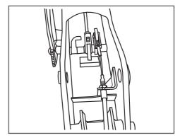
Dévisser et enlever la vis Allen du boulon inférieur du dispositif d'attelage. Enlever alors la rondelle et sortez le boulon à l'aide d'un chasse-boulon (Ne pas endommager le taraudage).
