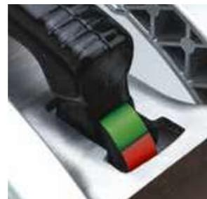
Témoin d'usure de coupelles de friction avant/arrière et mécanisme d'attelage.
