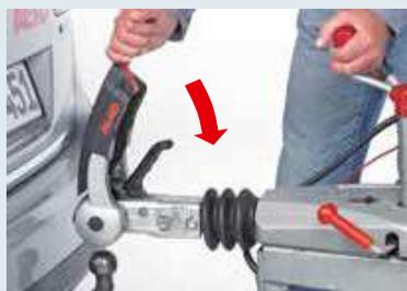
Mettre l'AKS™ en place sur la boule à l'aide de la poignée de tête d'attelage (la boule doit être exempte de graisse et nue). Déplacer la poignée de tête d'attelage vers le bas.
