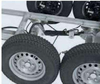
La disposición de los cilindros hidráulicos en los ejes tandem desempeña además la función de equilibrio de cargas entre el eje delantero y el trasero. En lugar del compensador, durante la marcha actúan ambos cilindros hidráulicos proporcionando un reparto regular de la carga sobre ambos ejes.
