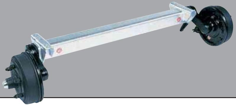
**2.2 Essieux à suspension caoutchouc SWING, freinés, charge sur essieu 2 100 kg, freins de roue S 3006-7 RASK**
