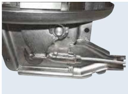
I Sortie câble de frein 90° (pas de flexion lors de l'abaissement). Guidage de câble de frein soudé.
