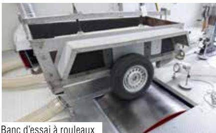
Banc d'essai à rouleaux
