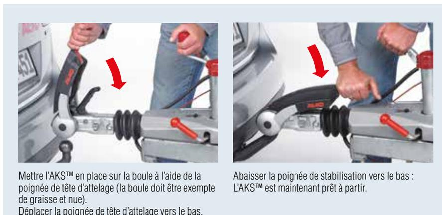
Mettre l'AKS™ en place sur la boule à l'aide de la poignée de tête d'attelage (la boule doit être exempte de graisse et nue). Déplacer la poignée de tête d'attelage vers le bas.
