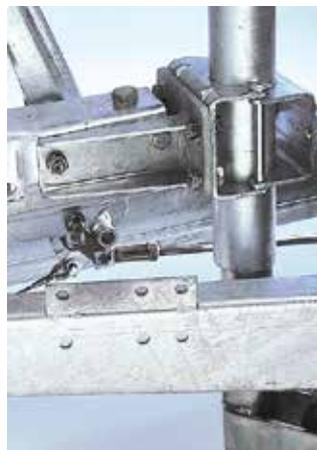
Le support de roue jockey permet un montage central de la roue jockey (attention lors de l'actionnement de la roue jockey, à veiller à ce que la roue ne puisse pas se coincer dans la tringlerie).
