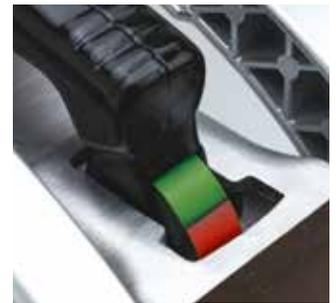
Témoin d'usure de coupelles de friction avant/arrière et mécanisme d'attelage.
