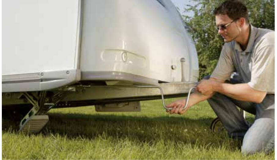
Les vérins stabilisateurs AL-KO sont conçus pour offrir une charge d'appui statique maxi avec une position à 45°. Si les vérins sont positionnés à 30°, la charge d'appui diminue (voir croquis).
