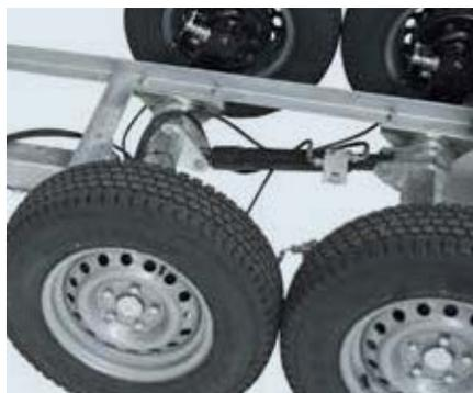
La disposition des cylindres hydrauliques au niveau des essieux tandem remplit en plus la fonction de compensation de charge entre l'essieu avant et l'essieu arrière. Les deux cylindres hydrauliques agissent en roulant, se chargeant donc d'une répartition homogène de la charge sur les deux essieux à la place du palonnier.
