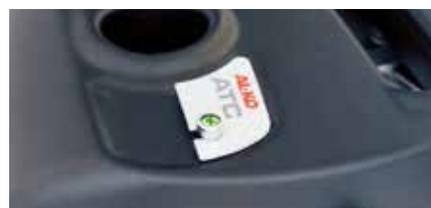
La diode lumineuse sur la commande de freinage est allumée en vert en continu. Le système est 100 % fonctionnel.
