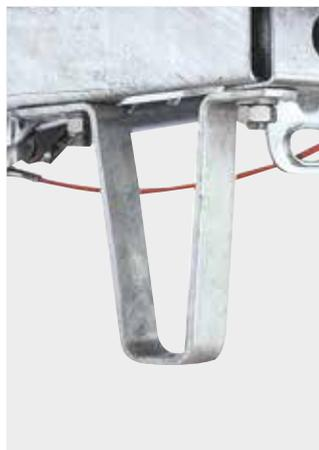
Une béquille en V évite l'enclassement de l'accrochage lié au contact avec le sol. De plus, le fonctionnement du frein de secours est garanti de façon sûre par le câble de rupture d'attelage.
