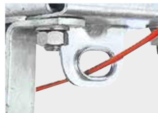
Guide-câble de rupture de série pour que le frein de secours fonctionne au mieux.
