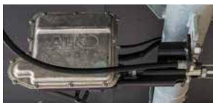
Le système ATC Trailer-Control démarre automatiquement un test de fonctionnement.
