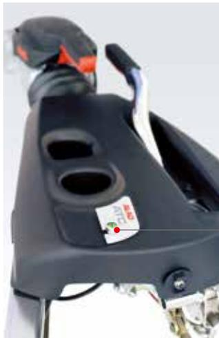
Interrupteur magnétique pour activer la télécommande
