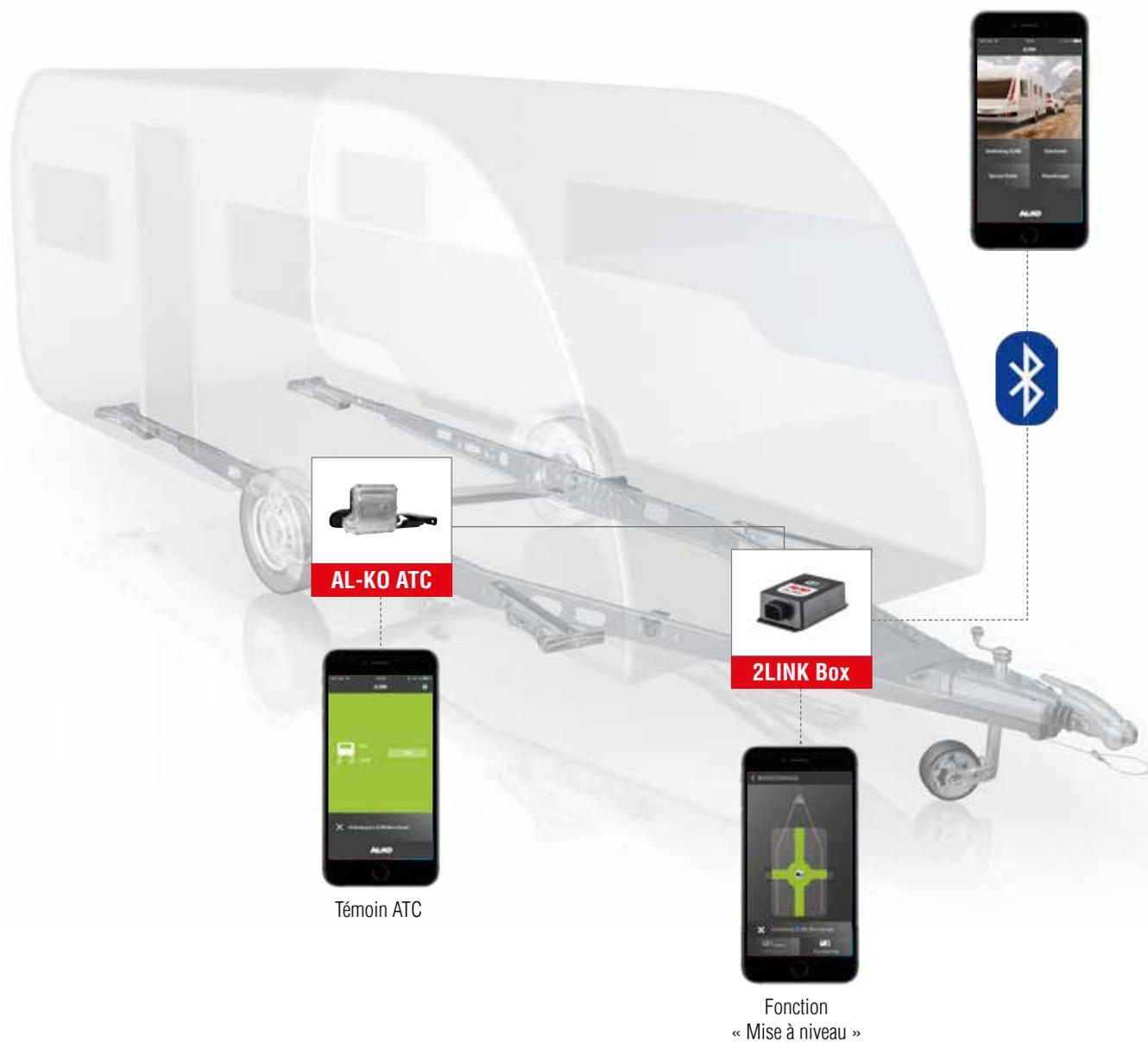
Par émetteur, l'ATC confirme son bon fonctionnement sur un affichage optique situé dans le véhicule tracteur. Un écran en option visualise les données des capteurs de surveillance. Le conducteur peut en temps réel être informé de la tenue de route de sa caravane et adapter sa conduite en fonction. Une installation en post-équipement est possible sur l'ATC existant.
