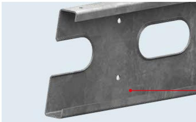
Certains composants du châssis sont munis de trous oblongs, c'est-à-dire que nous réduisons le poids à des endroits non critiques du châssis (zone neutre). Lors de cette étape de fabrication, les trous oblongs sont emboutis, c'est-à-dire que les bords sont déformés pour, autant que possible, ne pas générer de perte de stabilité.
