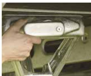
Positionner le Safety dans les encoches et pousser vers la droite.
