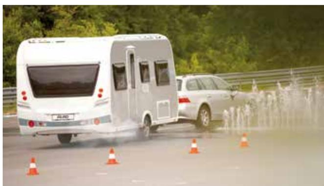
Le système de stabilisation ATC AL-KO peut être utilisé en plus de l'ESP de la remorque dans le véhicule, qui est offert par certains constructeurs automobiles.
