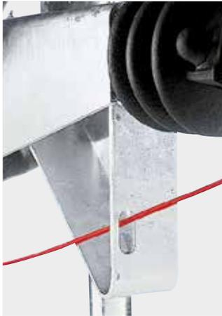
Une béquille en V intégrant un guide-câble de rupture évite l'encrassement de l'attelage. De plus, le câble de rupture est parfaitement guidé de façon à agir efficacement en cas de freinage d'urgence.
